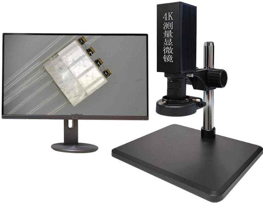
4K 高清测量显微镜系列采用华为海思 4K（分辨率 3840\*2160 即 800 万像素）全高清成像，HDMI 数字高清输出，外接 U 盘存储，显微镜相机内部自带 LINUX 操作系统，内置图像测量软件，抛开传统的电脑，自由实现拍照、录像、图像回看、图像对比、十字线、测量数据、图元保存、数据 EXCEL 导出、点间距、点线距、线间距、平行线、圆心距、点心距、角度、弧度、圆形、矩形、多边形、折线、圆边距等测量功能，以及智能寻边、局部放大、曝光值、亮度、增益、饱和度、对比度、清晰度、消反光、白平衡、自动曝光等。设计合理，操作简单，可满足大部分用户需求。
