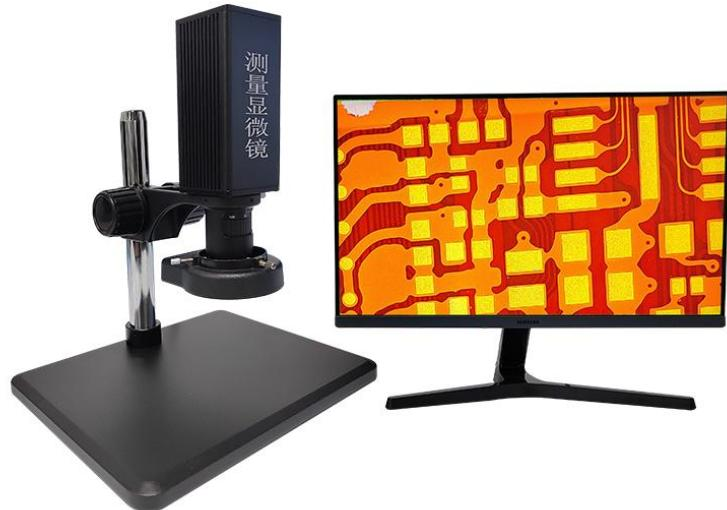
高清测量显微镜系列采用 2K（分辨率 1920\*1080 即 200 万像素）全高清成像，60FPS 高速无拖影，HDMI 数字高清输出，外接 U 盘存储，显微镜相机内部自带 LINUX 操作系统，内置图像测量软件，抛开传统的电脑，自由实现拍照、录像、图像回看、图像对比、十字线、注释测量数据、图元保存、数据 EXCEL 导出、点间距、点线距、线间距、平行线、圆心距、点心距、角度、弧度、圆形、矩形、多边形、折线、圆边距等测量功能，以及智能寻边、曝光值、亮度、增益、饱和度、对比度、清晰度、消反光、白平衡、自动曝光等。设计合理，操作简单，可满足大部分用户需求。
